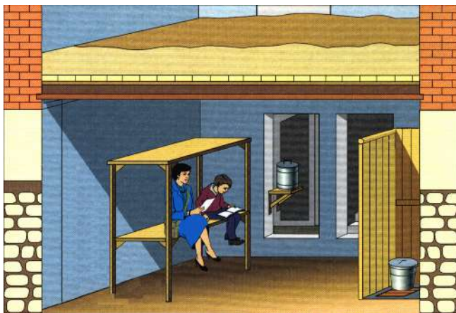
Рис. 4 — Подвал, приспособленный под укрытие
